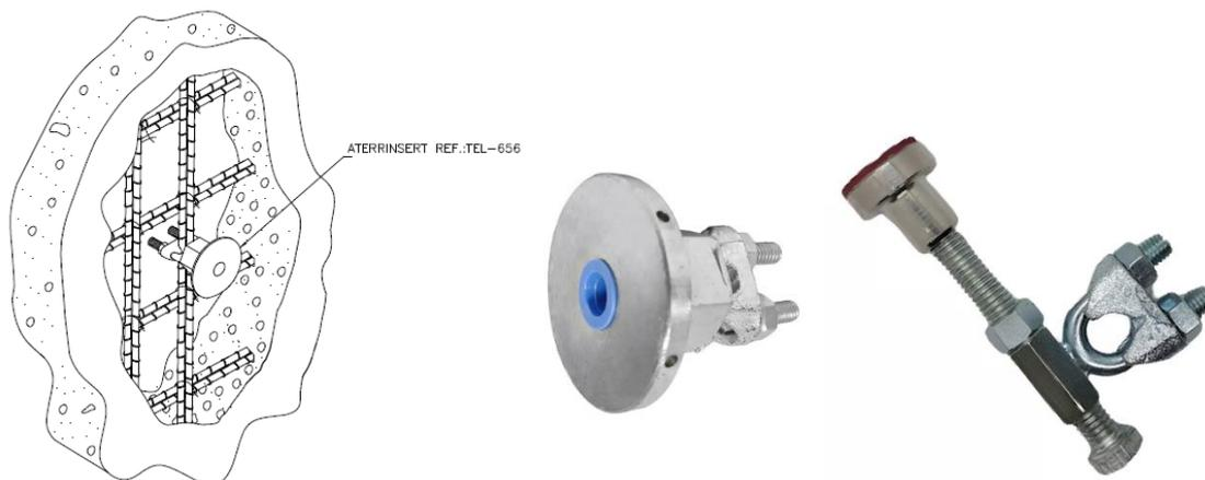
A conexão com a malha pode ser feita através do auxílio de um condutor de cobre nú de 35mm<sup>2</sup> utilizando conector olhal estanhado (o contato do cobre diretamente com a barra de alumínio é extremamente prejudicial ao material devido a ocorrência de pilha galvânica), ou (mais recomendado) através da conexão direta com a barra de alumínio através de parafuso e redutor adequados.
